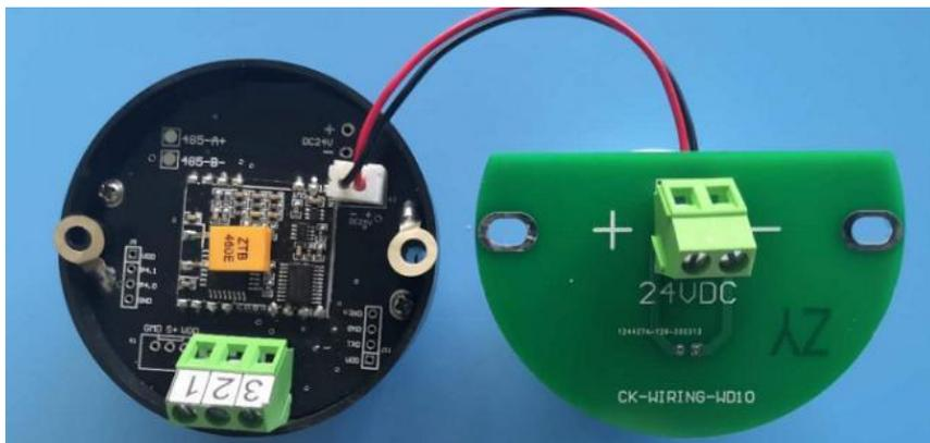
图 6 内部传感器与转换模块接线
