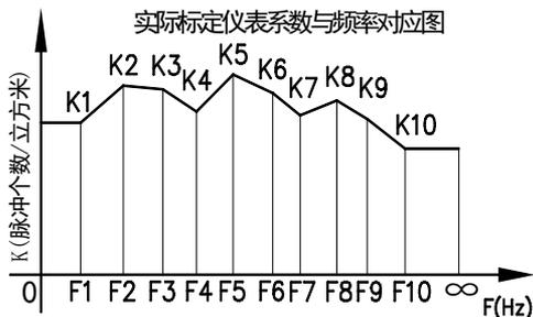
图 15 实际标定仪表系数与频率对应图
