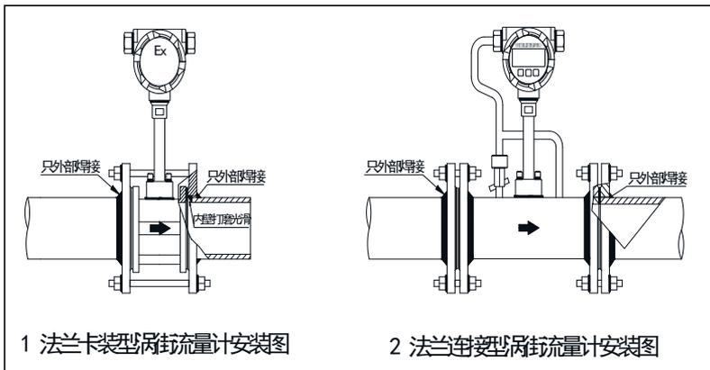
图 4 涡街流量计安装及焊接示意图
