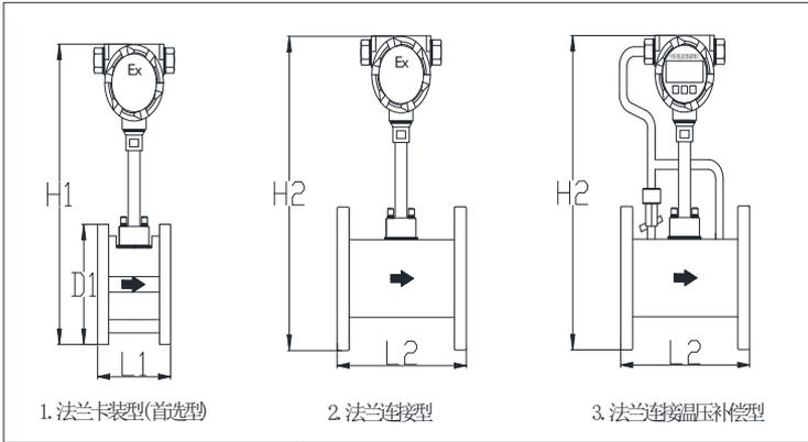
图 2 涡街流量计外形结构示意图
