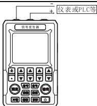
图 2 输出有源电流/电压到仪表或 PLC
